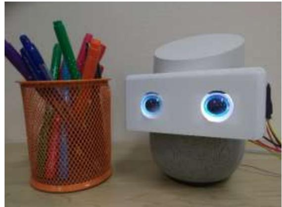
図 1 開発した瞳孔反応を表現する AI アシスタントスピーカー
